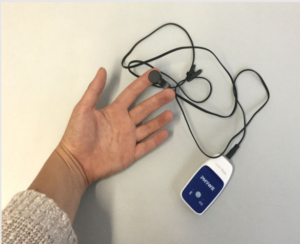
Medición del pulso: Medición con el sensor de infrarrojos en la yema del dedo
