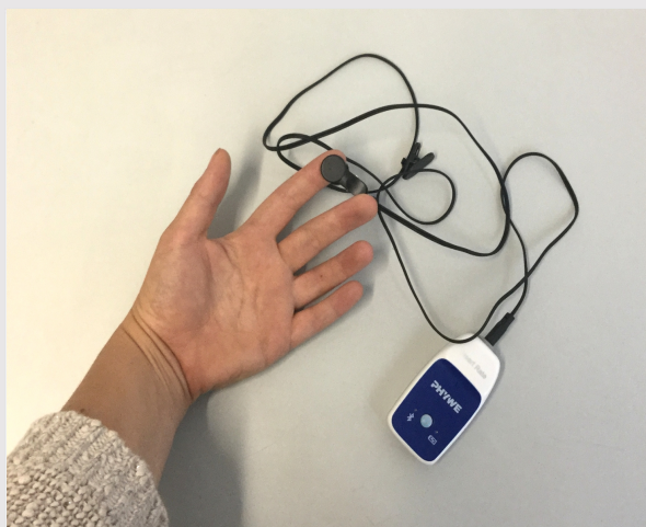
Измерение пульса: измерение с помощью инфракрасного датчика на кончике пальца
