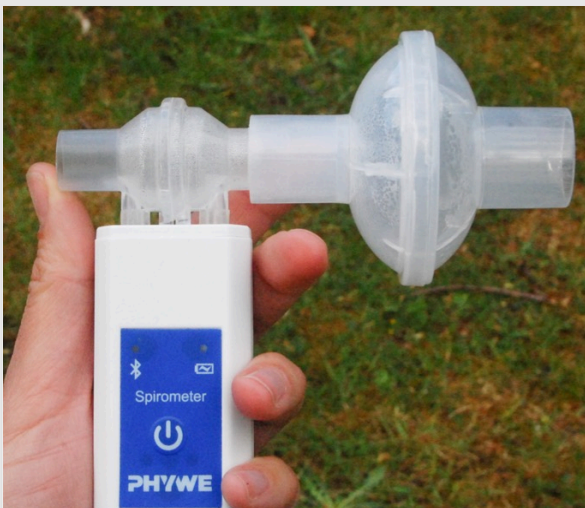
Spirometer mit korrekt angebrachter Turbine
