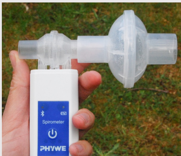
Спірометр із правильно встановленим загубником (мундштуком)
