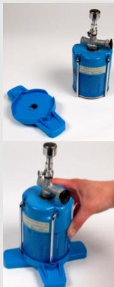
Colocar el quemador de butano en el cartucho de butano como se muestra en las ilustraciones de la izquierda. Utilizar cerillas para encender el quemador de butano.
