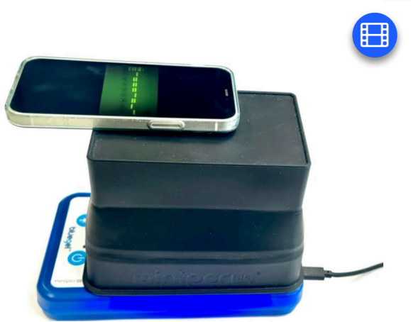
Das blueGel-Elektrophoresesystem mit integriertem Leuchtschirm und Dunkelkammer
