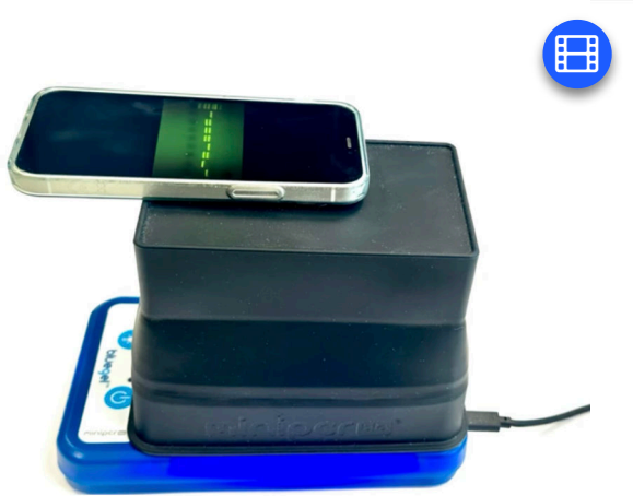
Das blueGel-Elektrophoresesystem mit integriertem Leuchtschirm und Dunkelkammer
