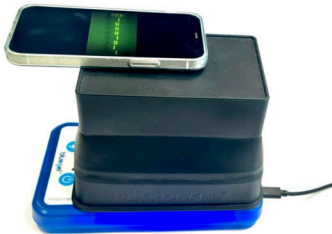
Gelkammer mit Dunkelkammer und Smartphone
