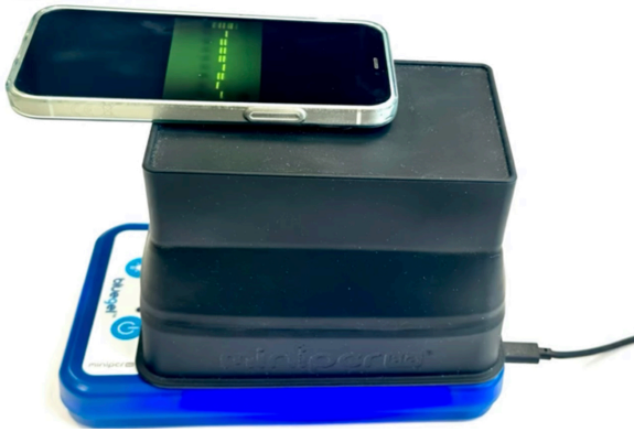
blueGel-Elektrophoresegerät mit Dunkelhaube und Live-Bild
