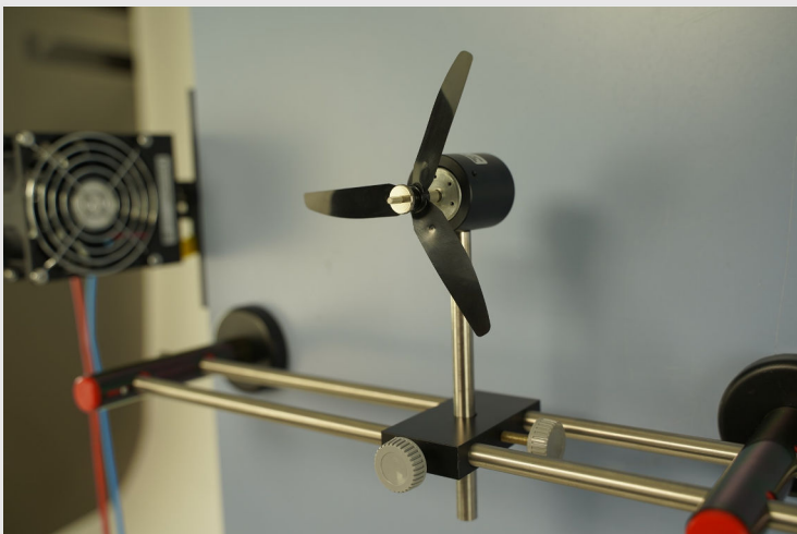
Versuchsteil 2: Windrad mit drei Rotorblättern
