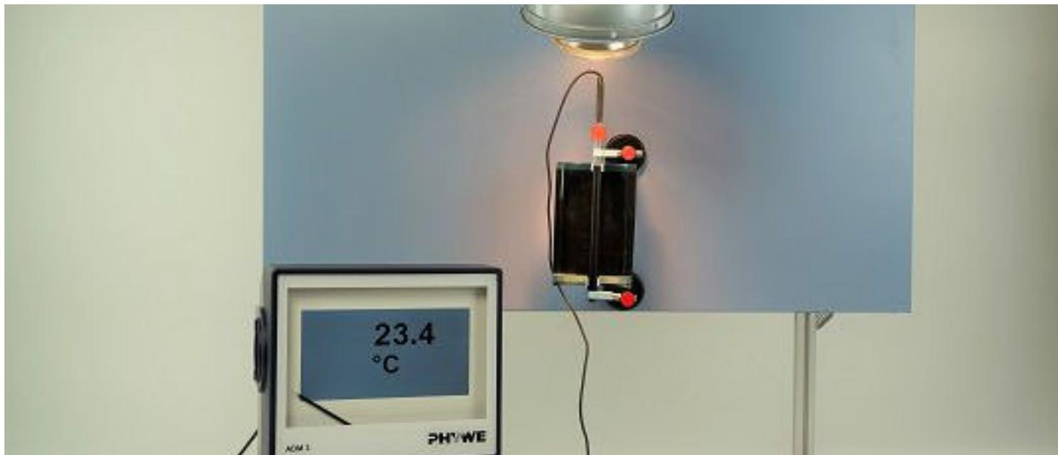
Erwärmen von Wasser mit einer Parabolrinne
