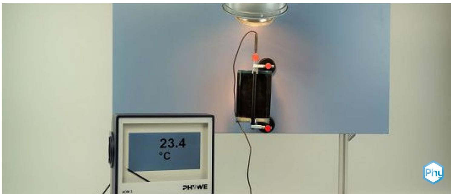
Calentar agua con un cilindro parabólico
