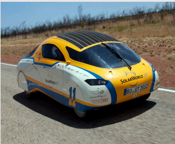
Solarzellen auf dem Dach des Experimentierfahrzeugs SolarWorld GT
