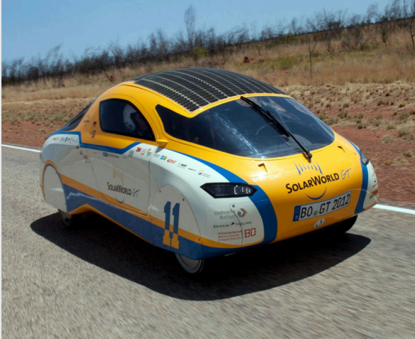
Células solares en el techo del vehículo experimental SolarWorld GT
