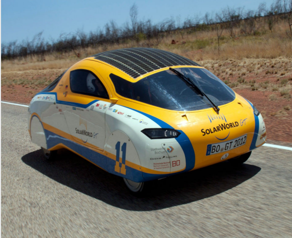
Сонячні батареї на даху експериментального автомобіля SolarWorld GT
