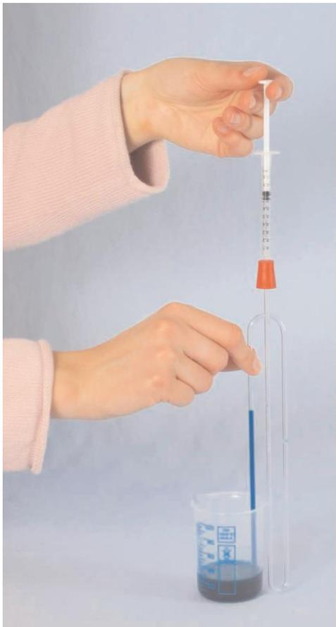
Abb. 2 Blasenfreies Befüllen des U-Rohres
