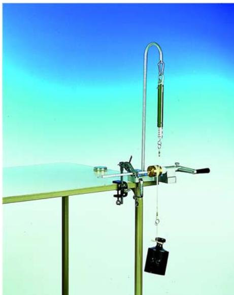
Abb. 1: Apparat zum mechanischen Wärmeäquivalent 04440-00
