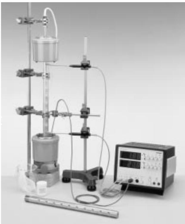
Abb. 2: Komplette Meßanordnung zur Bestimmung der Wärmeleitfähigkeit von Cu und Al
