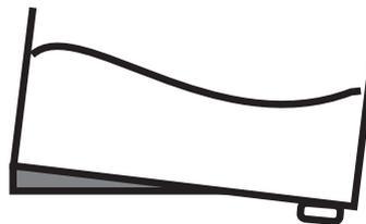
Die Durchfluss Box hat einen Auslass an den die Durchfluss Sets angeschraubt werden können. Außerdem ist sie mit einer schrägen Unterlage versehen, damit das Wasser bis zuletzt kontinuierlich abfließen kann.
