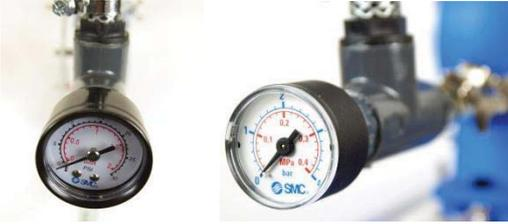
Mithilfe der Manometer Sets kann man den Druck an den zwei Zuläufen der Wasserturbine analog ablesen. Das 4 bar Set ist dabei an dem unteren und das 2 bar Set an dem oberen Zulauf montiert.
