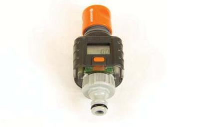
Der Wassermengenzähler wird auf den Zulaufverbinder aufgesteckt. Er hat verschiedene Programme, die man durch Betätigen der Taste wechseln kann. Für die hier beschriebenen Experimente wird immer die Einstellung in „Liter pro min“ verwendet.
