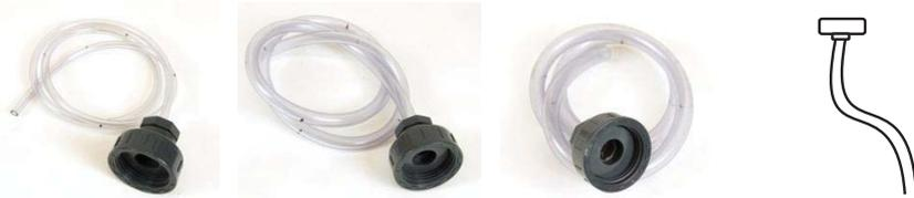
Die Durchfluss-Sets bestehen jeweils aus einem 1m langen Schlauch mit den Innendurchmessern 4mm, 8mm und 12mm und einer Anschlusskappe, die an die Unterseite der Durchflussbox angeschraubt werden kann. Zur Markierung der Fallhöhe gibt es an jedem Schlauch einen O-Ring, welcher an die gewünschte Stelle verschoben werden kann.
