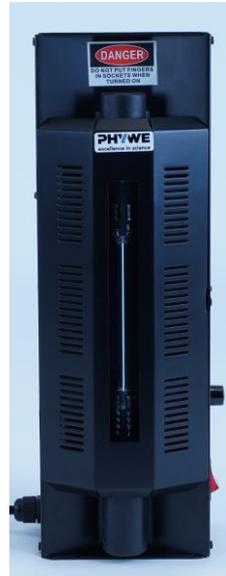
Abb. 1: 06673-93 Spektralröhren Netzgerät mit Halter
