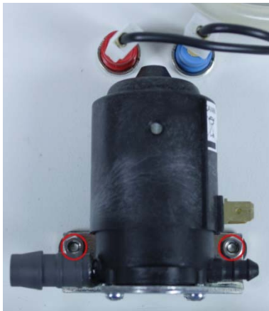
Abb. 2: Befestigung der Pumpe am Gestell.
