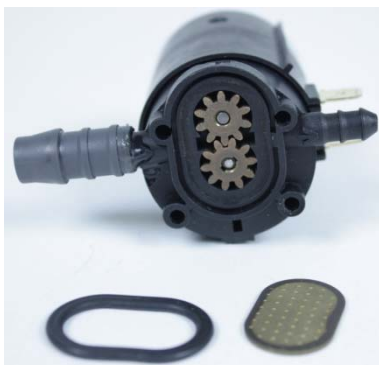
Abb. 4: Reinigen der Zahnräder im Inneren der Pumpe.
