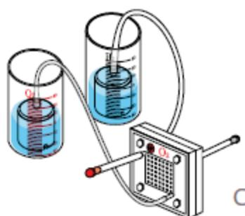
6. Der Elektrolyseur wird anschließend auf die Modulplatte aufgebracht und mit den jeweiligen Kabeln verbunden (rotes Kabel auf O<sub>2</sub>-Seite, schwarzes Kabel auf H<sub>2</sub>-Seite).
