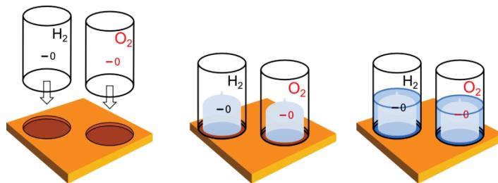
4. Je ein Gasvorratsbehälter („Glocke“) wird auf den Halterungsring am Boden des Wasserbehälters aufgesteckt, sodass die Kerben am unteren Ende der Gasbehälter innerhalb der Unterbrechungen in den Halterungsringen liegen. Überschüssiges Wasser kann anschließend mit der Spritze abgesaugt werden.
