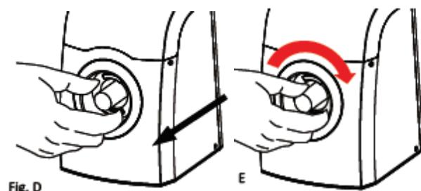
4. Während die Statusleuchte rot leuchtet, wird der H<sub>2</sub>-Storage gefüllt. Erst wenn die der Status ein grünes Leuchten anzeigt, ist die Kartusche vollständig aufgefüllt. Der Stick kann dann durch Drehen gegen den Uhrzeigersinn wieder entfernt werden.
