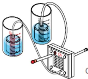
6. Der Elektrolyseur wird anschließend auf die Modulplatte aufgebracht und mit den jeweiligen Kabeln verbunden (rotes Kabel auf  $O_2$ -Seite, schwarzes Kabel auf  $H_2$ -Seite).
