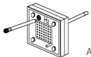
2. Nun wird die Spritze mit destilliertem Wasser befüllt und ein kurzes Schlauchstück auf die Spritze aufgesteckt. Das andere Ende des Schlauches wird mit dem oberen Anschluss auf der O<sub>2</sub>-Seite (roter Anschluss) verbunden (B).
