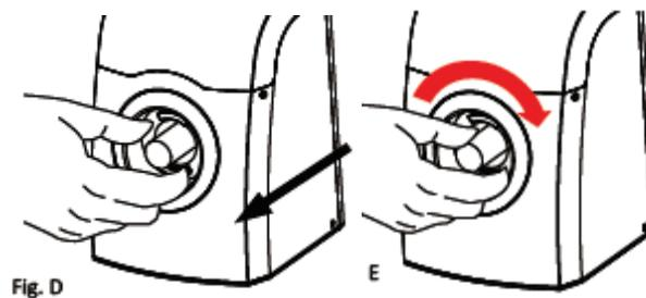
4. Während die Statusleuchte rot leuchtet, wird der H<sub>2</sub>-Storage gefüllt. Erst wenn die der Status ein grünes Leuchten anzeigt, ist die Kartusche vollständig aufgefüllt. Der Stick kann dann durch Drehen gegen den Uhrzeigersinn wieder entfernt werden.
