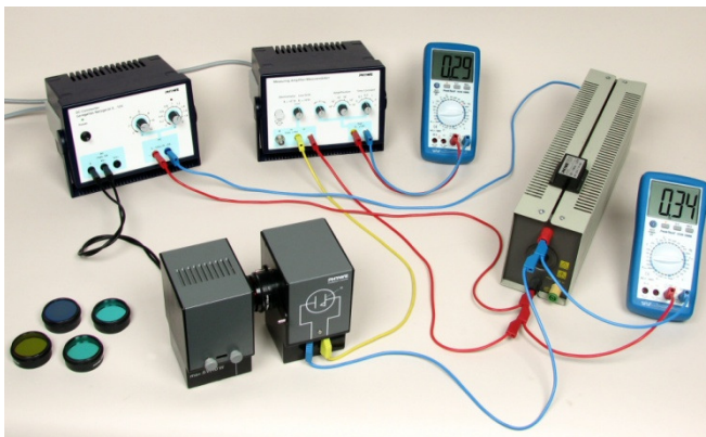
Abb. 4: Beispiel eines Versuchsaufbaus mit Interferenzfiltern
