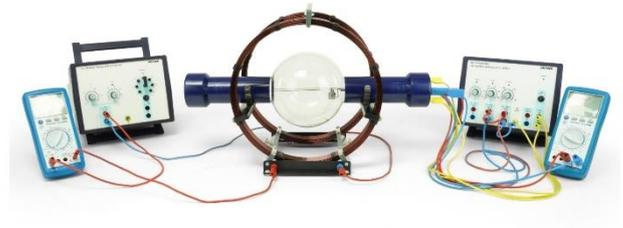
Abb. 3 Versuchsanordnung zur Bestimmung von  $e/m$  mit dem Fadenstrahlrohr P2510200.
