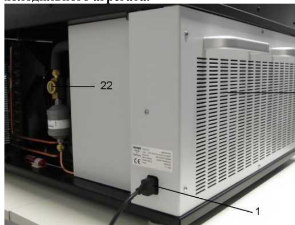
Рис. 5. Открытая задняя панель с блоком охлаждения.
