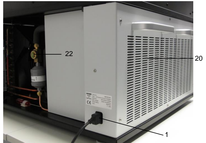
Abb. 5: Geöffnete Rückwand mit Kühlaggregat
