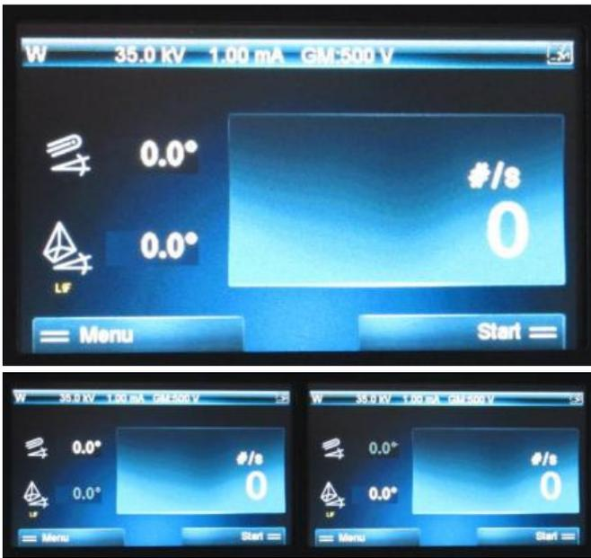
Abb. 4: oben: gekoppelter Modus, links: Detektor drehen, rechts: Kristall drehen.
