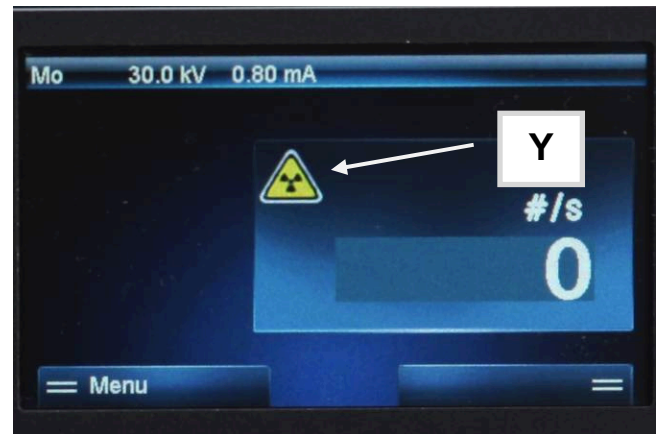
Fig. 11: Pantalla para controlar el aparato en la parte frontal del aparato. La alta tensión está activada. Aparece en la pantalla el símbolo Y.
