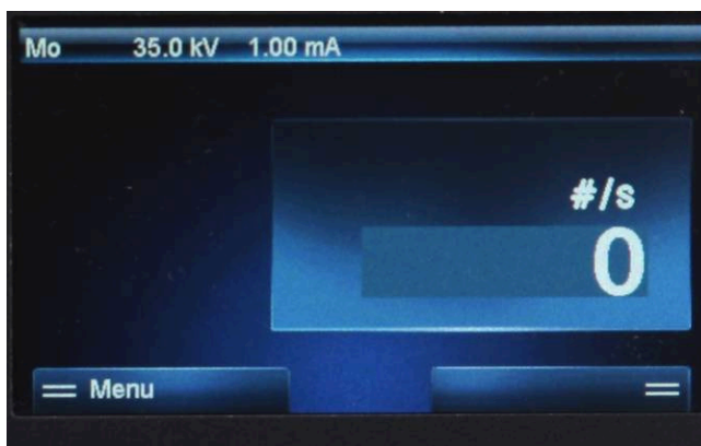
Fig. 10: Pantalla para controlar el aparato en la parte frontal del aparato. La alta tensión no está activada.
