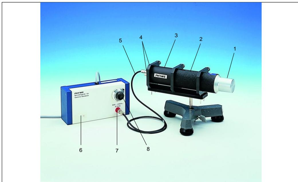
Abb. 1: Gamma-Detektor 09101-00 mit Betriebsgerät für Gamma-Detektor 09101-93.
