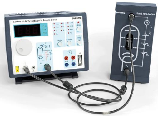
Abb. 3 : Aufbau des Franck-Hertz-Experiments mit Ne-Röhre
