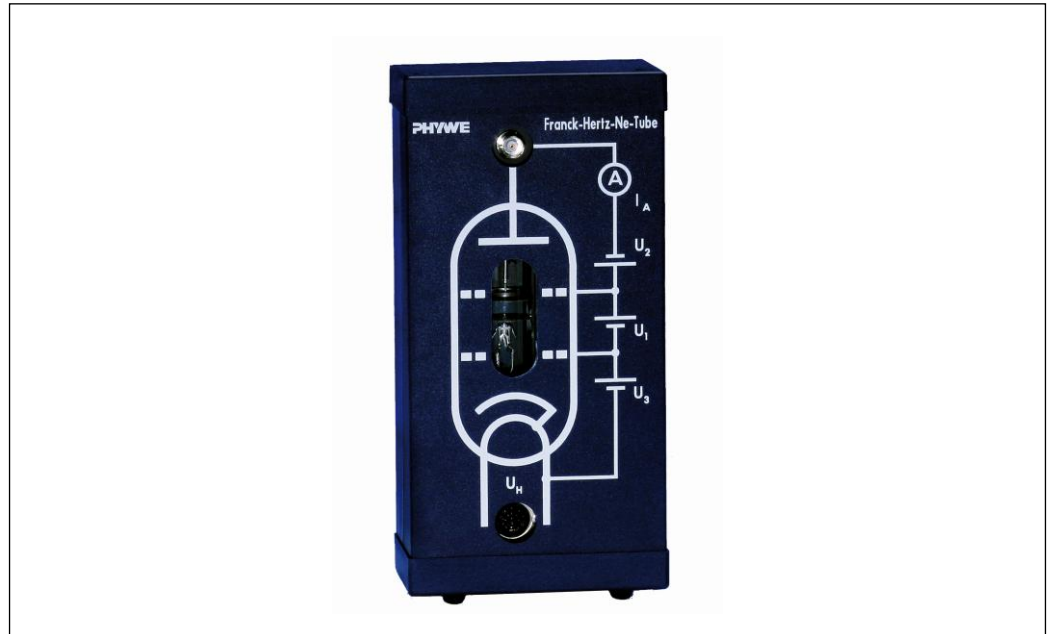
Abb. 1: Franck-Hertz Ne-Röhre mit Gehäuse
