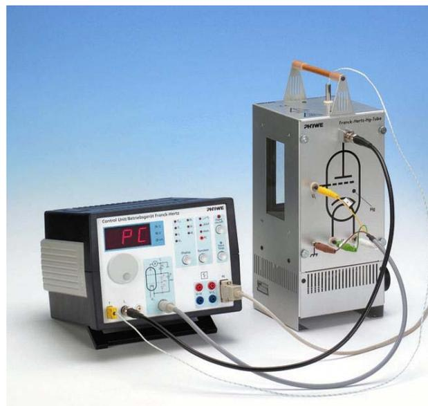
Abb. 2: Aufbau des Franck-Hertz-Experiments mit Hg-Röhre und Ofen
