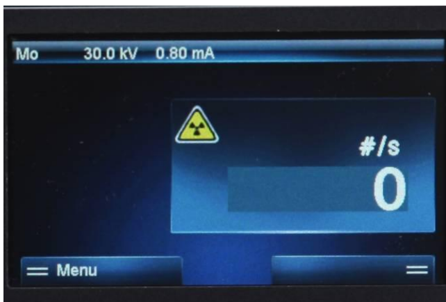
Abb. 11: Bildschirm zur Gerätesteuerung an der Vorderseite des Gerätes. Hochspannung ist aktiviert. Das Symbol ☠ erscheint im Bildschirm.
