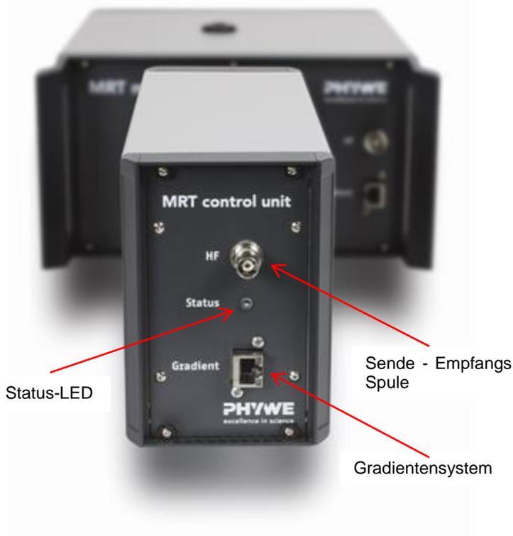
Abb. 2: Frontseite Steuereinheit
