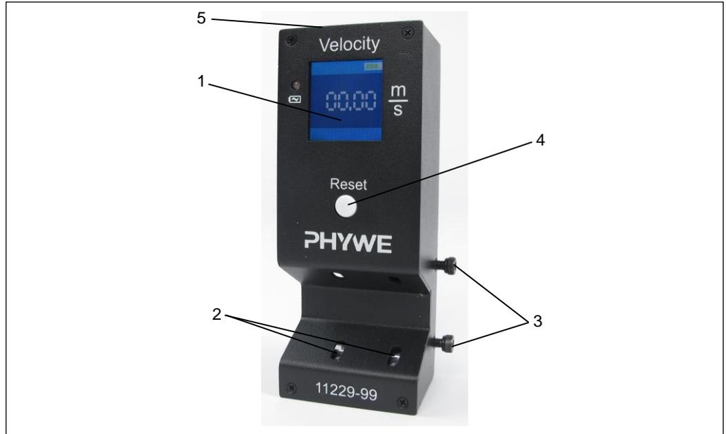
Abb. 1: Geschwindigkeitsmessaufsatz 11229-99.
