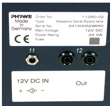
Abb. 4: Buchse zur Stromversorgung (11) und Buchsenpaar zum Verbinden des externen Erregers (12).
