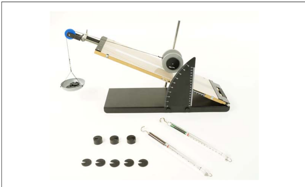
Abb. 1: Geneigte Ebene, Geräteset komplett, 11301-10
