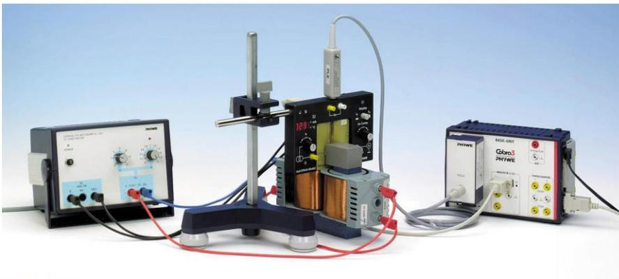
Abb. 4: Versuchsaufbau: Hall-Effekt an dotierten Germaniumproben mit Cobra3-Interface.
