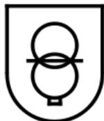
Sicherheitstransformator, Gerät kurzschlussfest durch Schutzmaßnahmen
