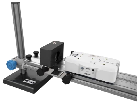
Kuva 7: Auto odottaa käynnistystä vapautuspainikkeella.
