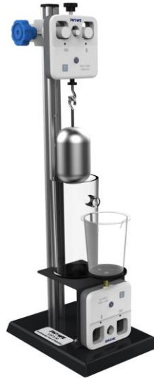
Abb. 1: 12971-00 Cobra SMARTexperiment - Archimedisches Prinzip
