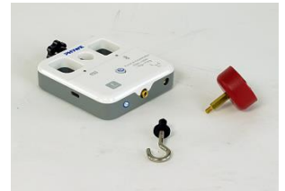
Abb. 11+12 Schwimmkörper und Sensor mit Magnet
