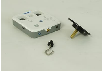
Abb. 7 Sensor mit Haken und Gewichtsteller
