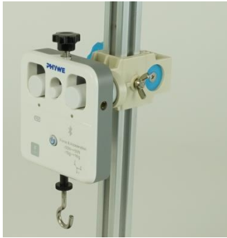
Abb. 14 Höhenversteller mit Flügelschraube
