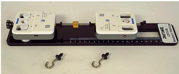
Abb. 6 Aufbau mit starrer Schraubverbindung
