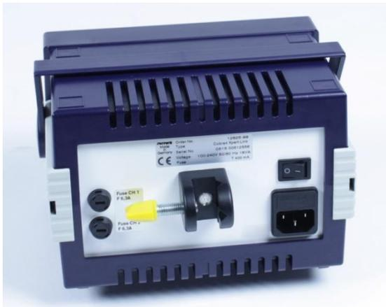
Abb. 2: Rückseite des Systemkleingehäuses mit Stativklemme
