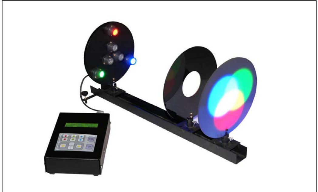
Abb. 1: 13761-99 LED Leuchte für Farbmischung
