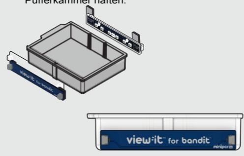
**6** Verbinden Sie ein Ende des Stromkabels mit einem der vier Anschlüsse an den LED-Streifen und das andere Ende an die Bandit™-Schaltung Controller.
