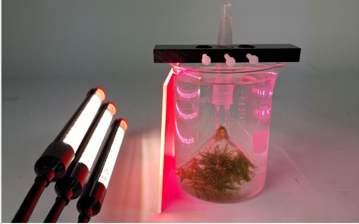
Versuchsaufbau mit Photosyntheselampe und rotem Farbfilter
