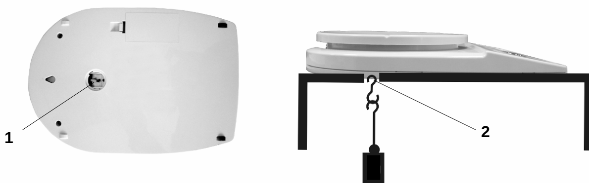
Abb. 1: Einrichten der Waage für Unterflurwägungen
