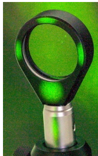
Abbildung 88: Die ersten Beugungsordnungen fallen nicht auf das Linsenglas.
