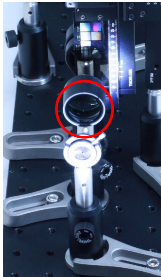
Abbildung 45: Die Apertur-Iris beschattet den Linsenhalter und die Kondensorlinse.
