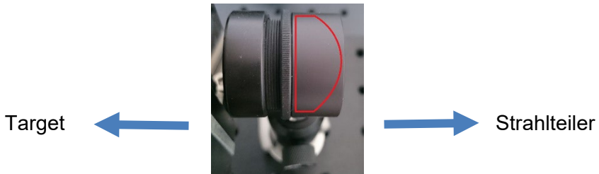
Abbildung 24 Orientierung der Objektivlinse
