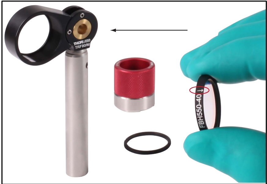
Abbildung 22 Zusammenbau des Grünfilters. Beachten Sie beim Einbau die Richtung des Pfeils am Gehäuse.
