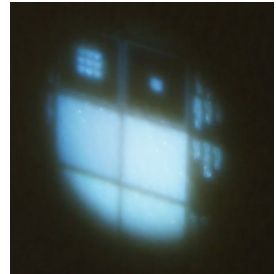
Abbildung 57 Foto des Bildes am Schirm, entstanden durch das Keplerfernrohr aus Feld- und Kondensorlinse
