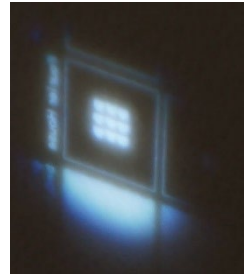
Abbildung 59 Foto des Bildes am Schirm, entstanden durch das Keplerfernrohr aus Kondensor- und Objektivlinse
