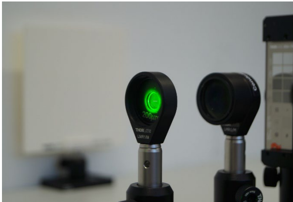
Abbildung 91: S200RD anstatt der Apertur-Iris vor der Kondensorlinse
