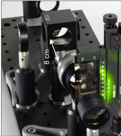
Abbildung 50: Der Halter des Strahlteilers sollte nicht beleuchtet sein.
