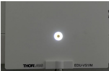
Abbildung 85 Kanten hervorheben und Kontrast erhöhen durch optische Hochpass
