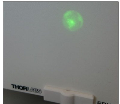
Abbildung 86: Inverses Fourier-Target in der Objektebene und Blick in die Fourier-Ebene.
